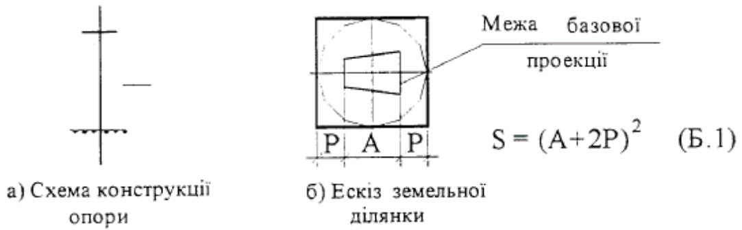
Рисунок Б.1 - Стояк одиничний з трапецієподібним перерізом
