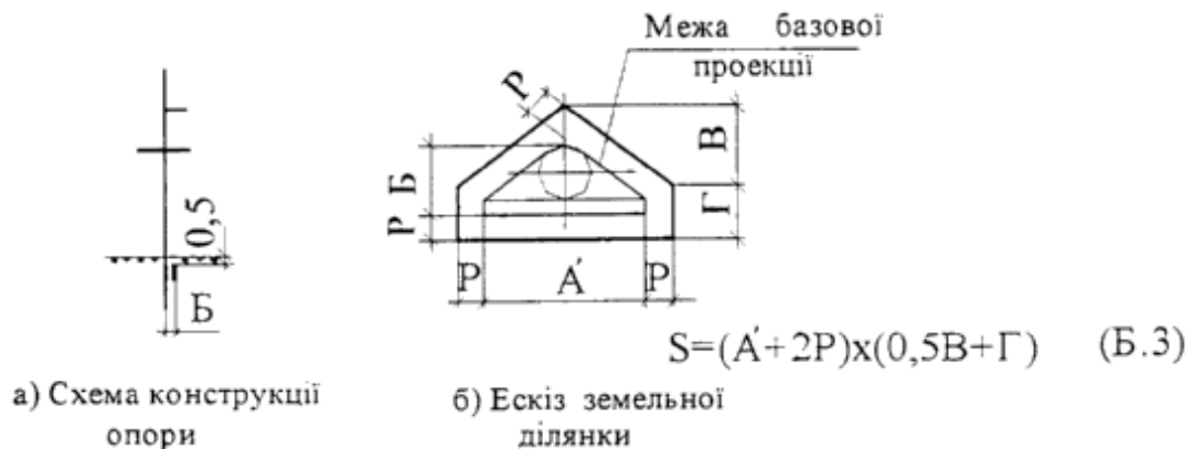
Рисунок Б.3 - Стояк одиничний з круглим перерізом з ригельним закріпленням у ґрунті при довжині ригеля понад 1 м
