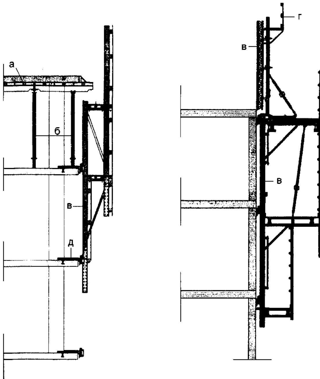
а – елементи системної горизонтальної опалубки робочого настилу; б – стояки системної опалубки; в-вертикальні елементи захисної огорожувальної системи; г–елементи огорожувальної системи робочого горизонту; д–елементи кріплення захисної огорожувальної системи до перекриття, розташованого нижче
