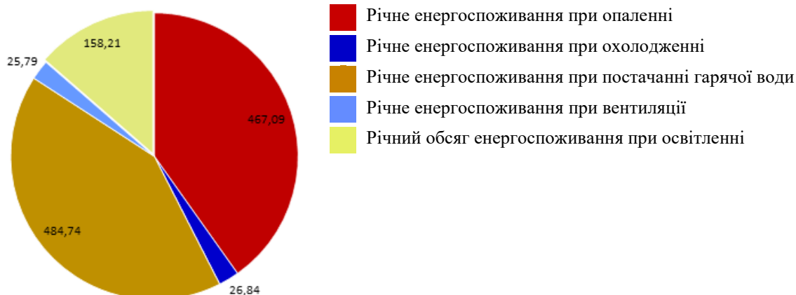
Діаграма річного енергоспоживання будівлі
