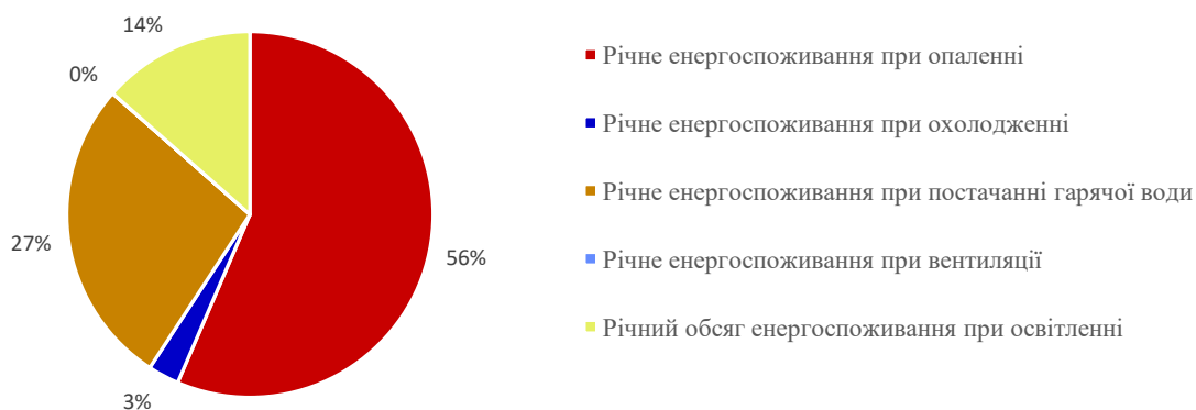
Діаграма річного енергоспоживання будівлі
