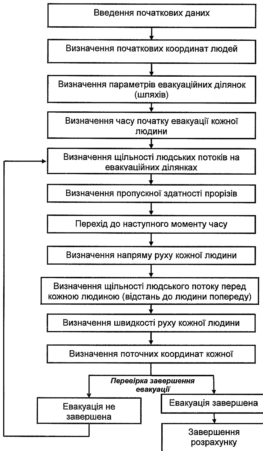
Рисунок 2.3 - Порядок визначення розрахункового часу евакуації людей (моделювання процесу евакуації)
