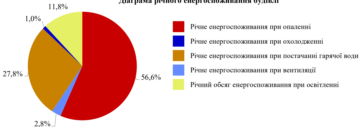
Діаграма річного енергоспоживання будівлі
