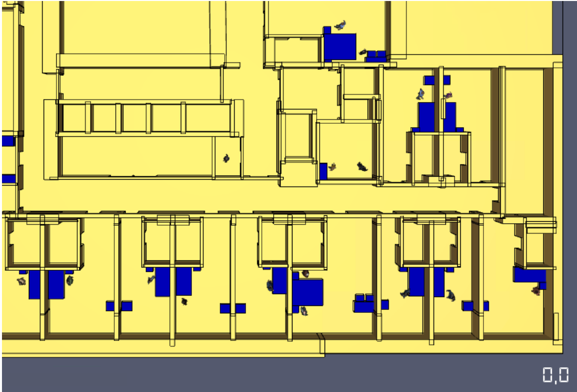
Рис. 82. Модель фрагменту плану 4 поверху з приміщенням № 414 із початковою розстановкою людей
