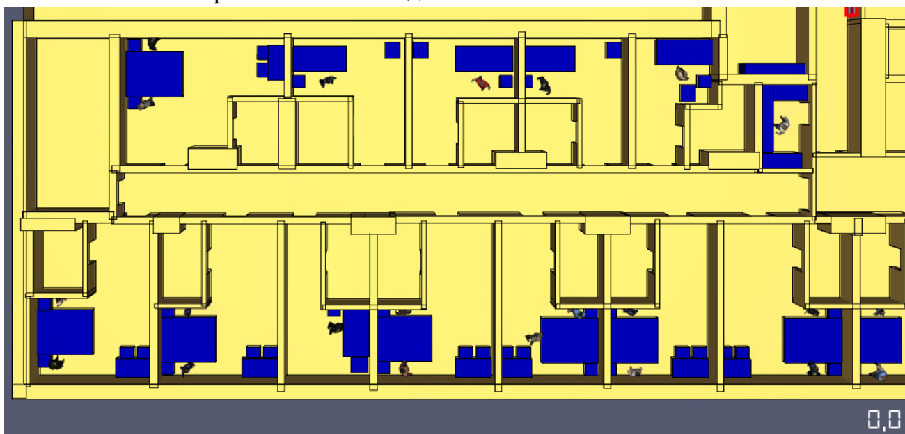
Рис. 182. Модель фрагменту плану 6 поверху з приміщенням № 618 із початковою розстановкою людей
