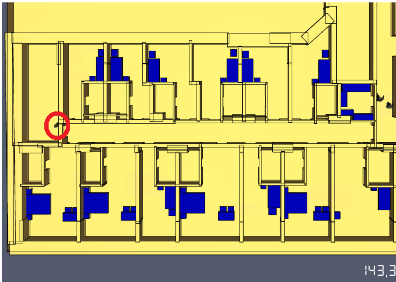
Рис. 75. Модель евакуації людей на фрагменті плану 4 поверху станом на 143,3 с.
