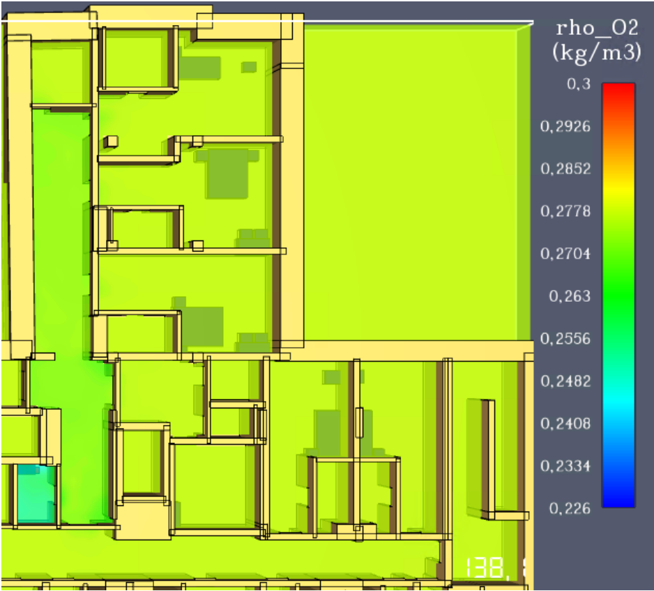
Рис. 119. Модель зниження концентрації кисню (O 2 ) на фрагменті плану 4 поверху станом на 138,1 с.
