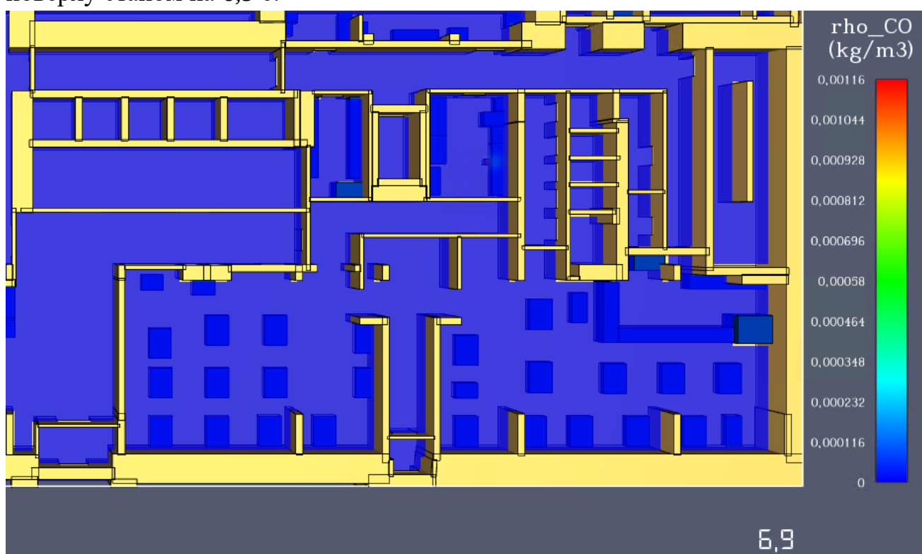
Рис. 26. Модель розповсюдження чадного газу (CO) на фрагменті плану 1 поверху станом на 6,9 с.
