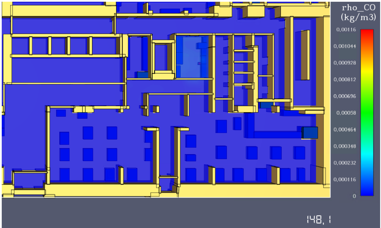
Рис. 38. Модель розповсюдження чадного газу (CO) на фрагменті плану 1 поверху станом 148,1 с.
