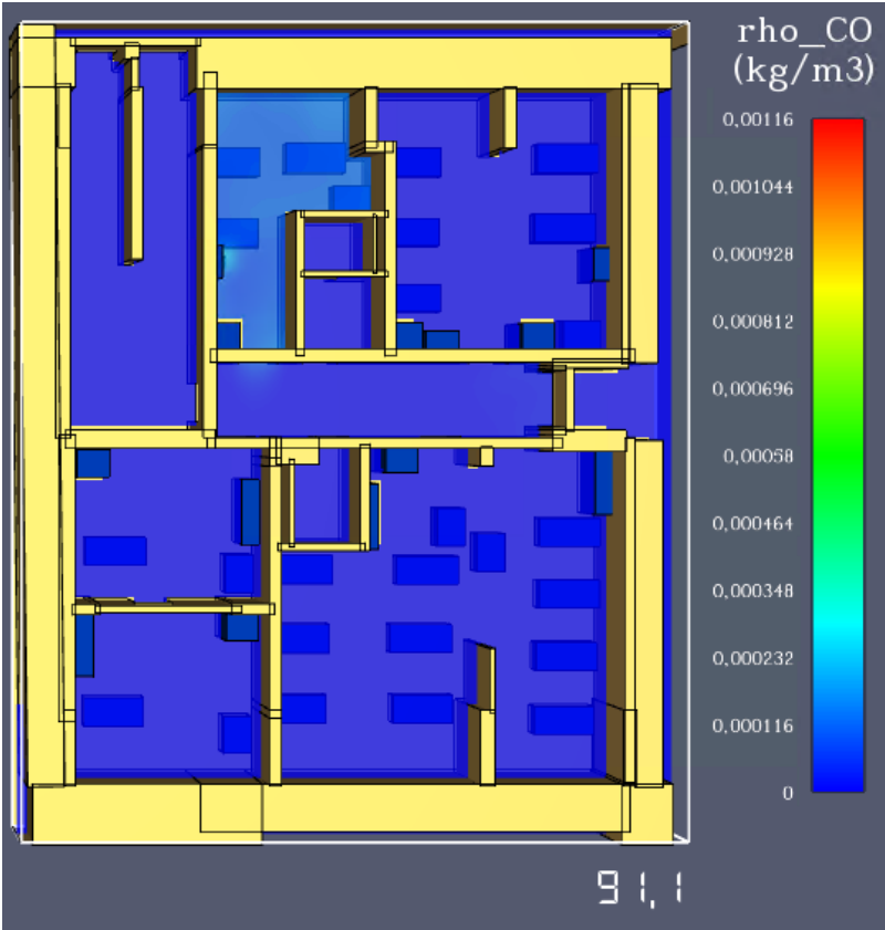
Рис. 18. Модель розповсюдження чадного газу (CO) на фрагменті плану 1 поверху станом на 91,1 с.
