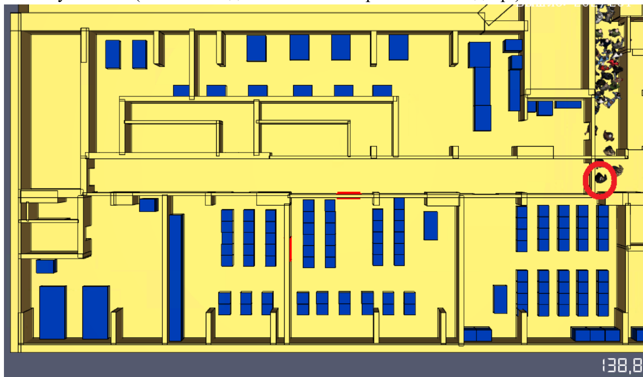
Рис. 135. Модель евакуації людей на фрагменті плану 5 поверху з приміщенням № 523 станом на 138,8 с.
