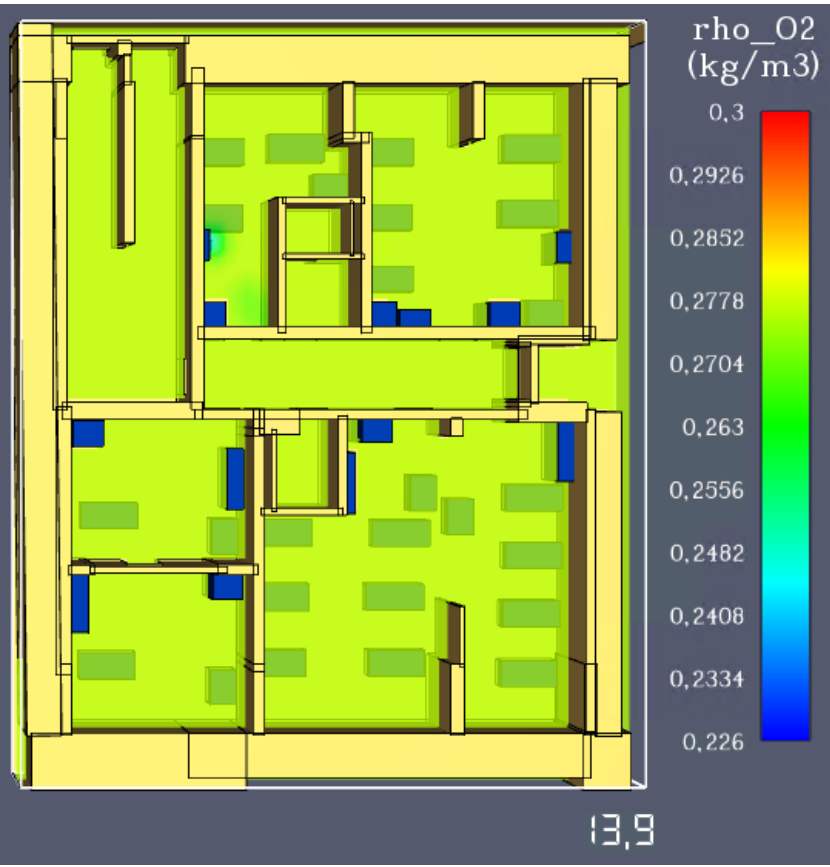
Рис. 7. Модель зниження концентрації кисню (O 2 ) на фрагменті плану 1 поверху станом на 13,9 с.
