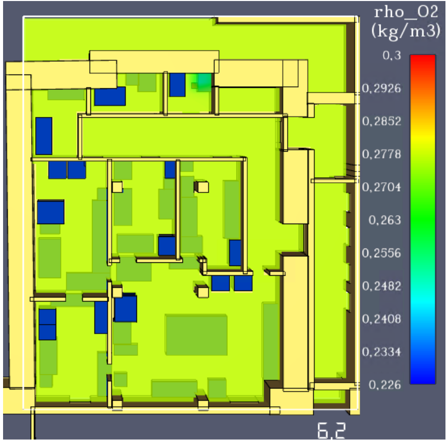
Рис. 47. Модель зниження концентрації кисню (O 2 ) на фрагменті плану 1 поверху станом на 6,2 с.
