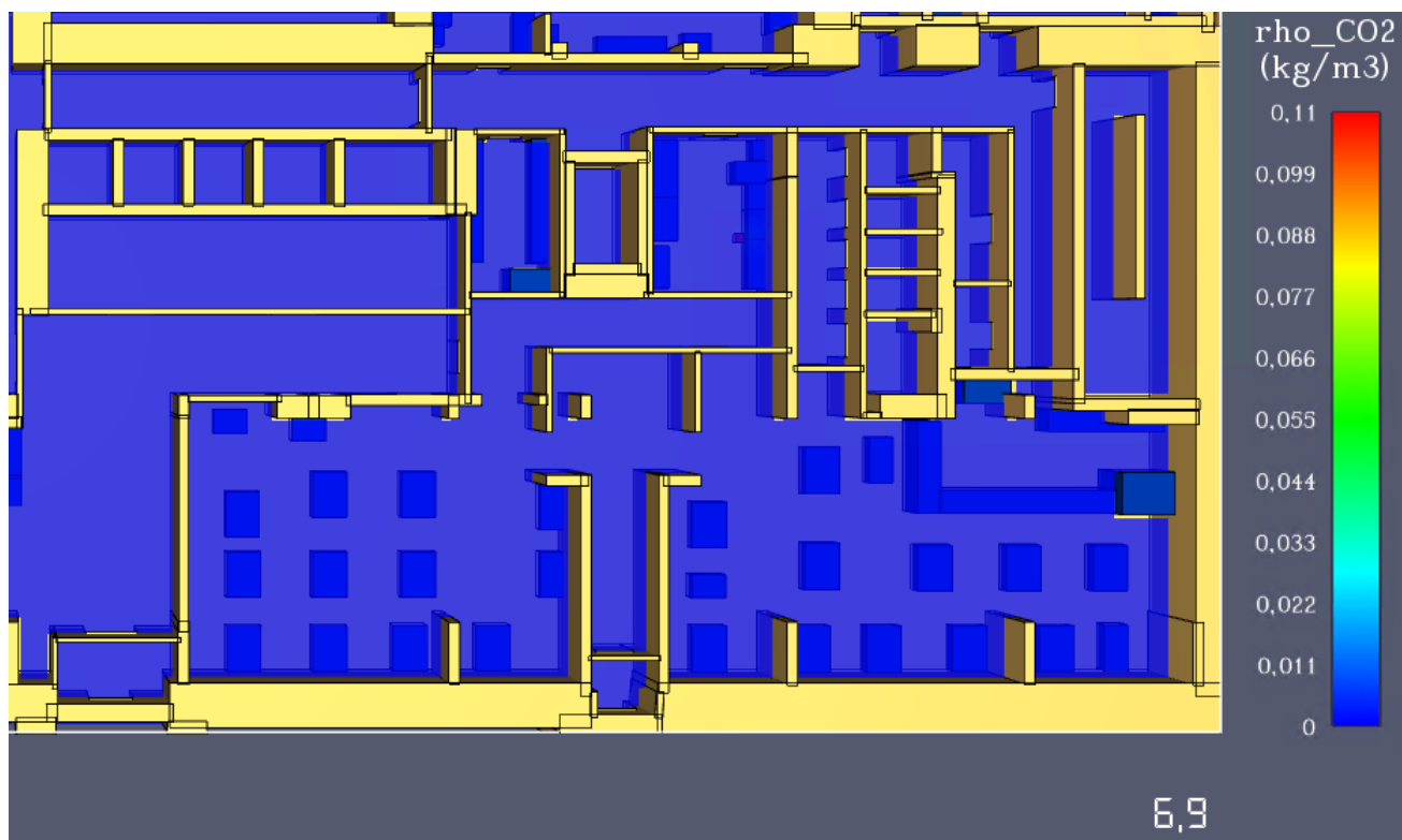
Рис. 25. Модель розповсюдження вуглекислого газу (CO 2 ) на фрагменті плану 1 поверху станом на 6,9 с.
