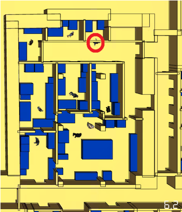
Рис. 43. Модель евакуації людей на фрагменті плану 1 поверху станом на 6,2 с.
