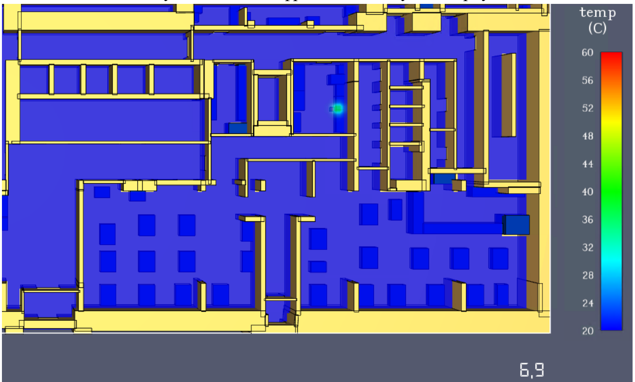
Рис. 24. Модель розповсюдження температури на фрагменті плану 1 поверху станом на 6,9 с.
