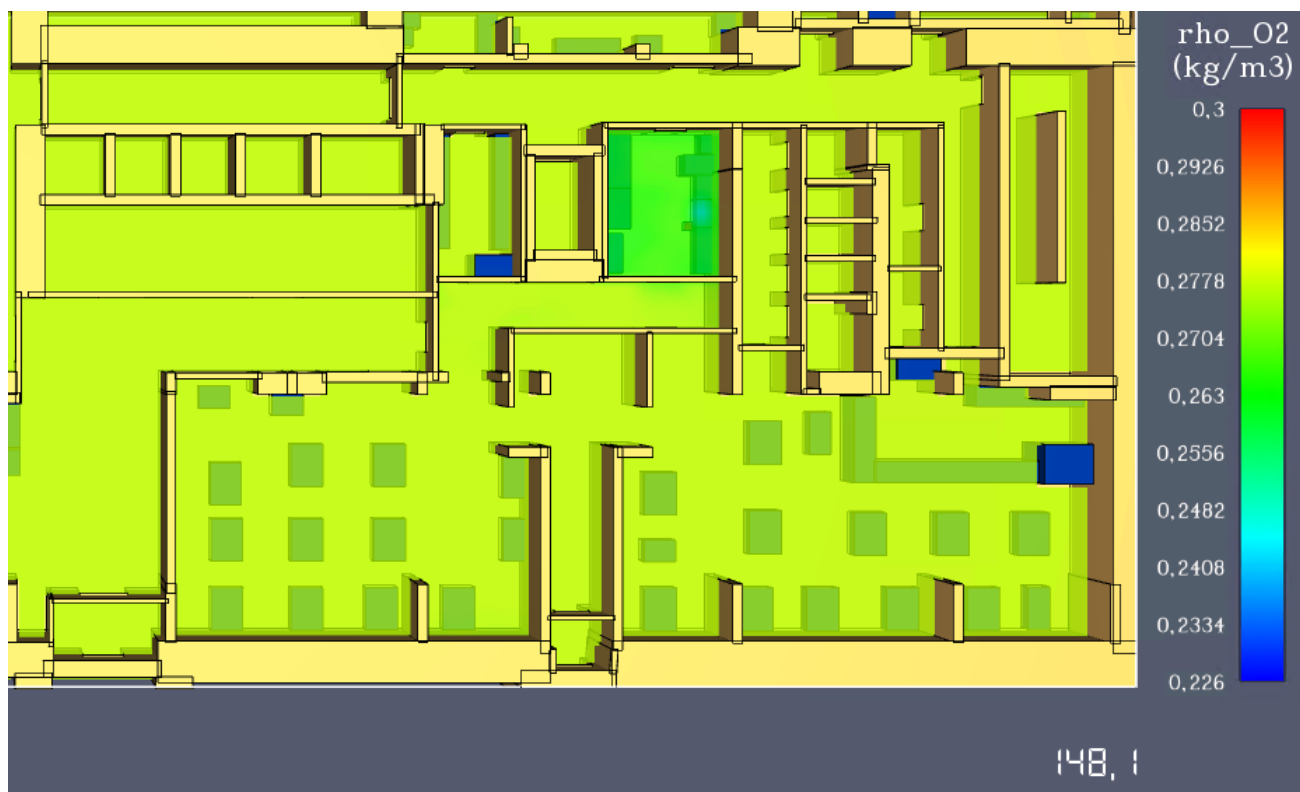
Рис. 39. Модель зниження концентрації кисню (O 2 ) на фрагменті плану 1 поверху станом 148,1 с.
