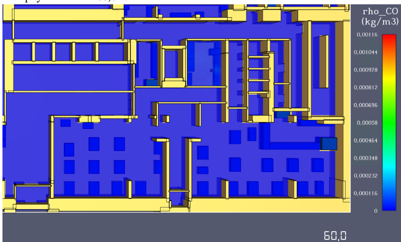
Рис. 32. Модель розповсюдження чадного газу (CO) на фрагменті плану 1 поверху станом на 60,0 с.
