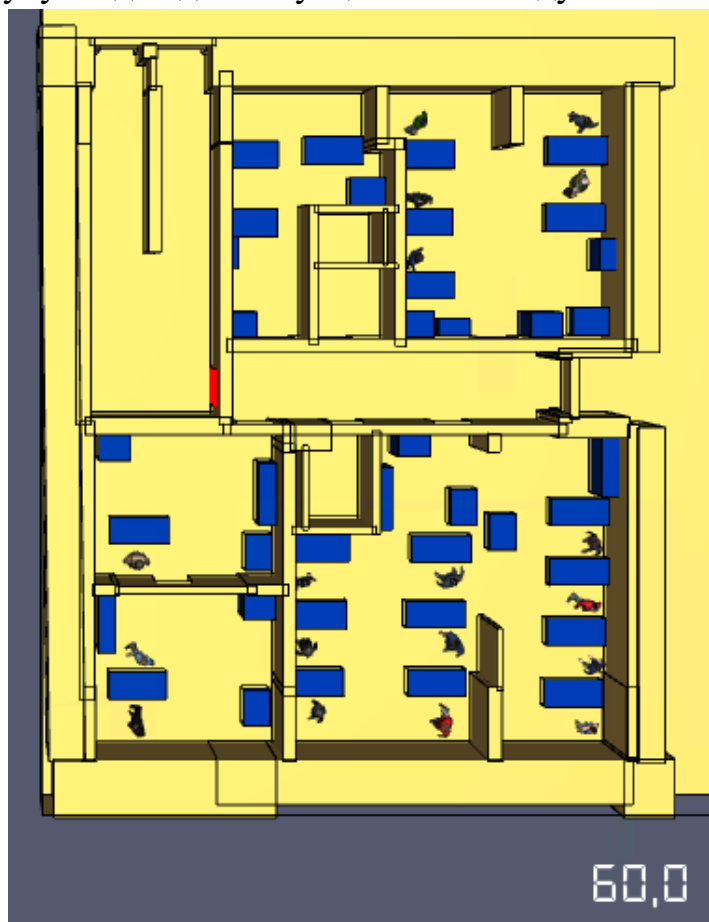
Рис. 9. Модель евакуації людей на фрагменті плану 1 поверху станом на 60,0 с.
