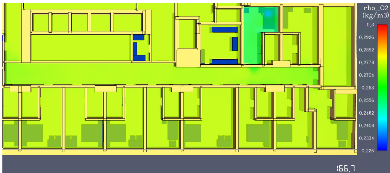
Рис. 219. Модель зниження концентрації кисню ( O_2 ) на фрагменті плану 6 поверху з приміщенням № 617 станом на 166,7 с.
