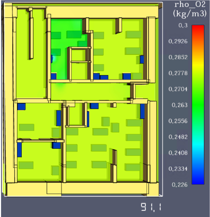
Рис. 19. Модель зниження концентрації кисню (O 2 ) на фрагменті плану 1 поверху станом на 91,1 с.
