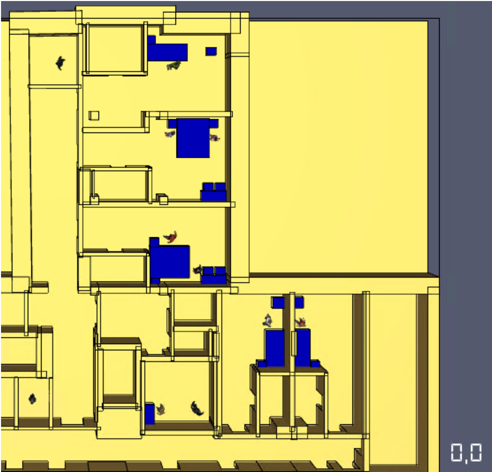
Рис. 102. Модель фрагменту плану 4 поверху з приміщенням № 442 із початковою розстановкою людей
