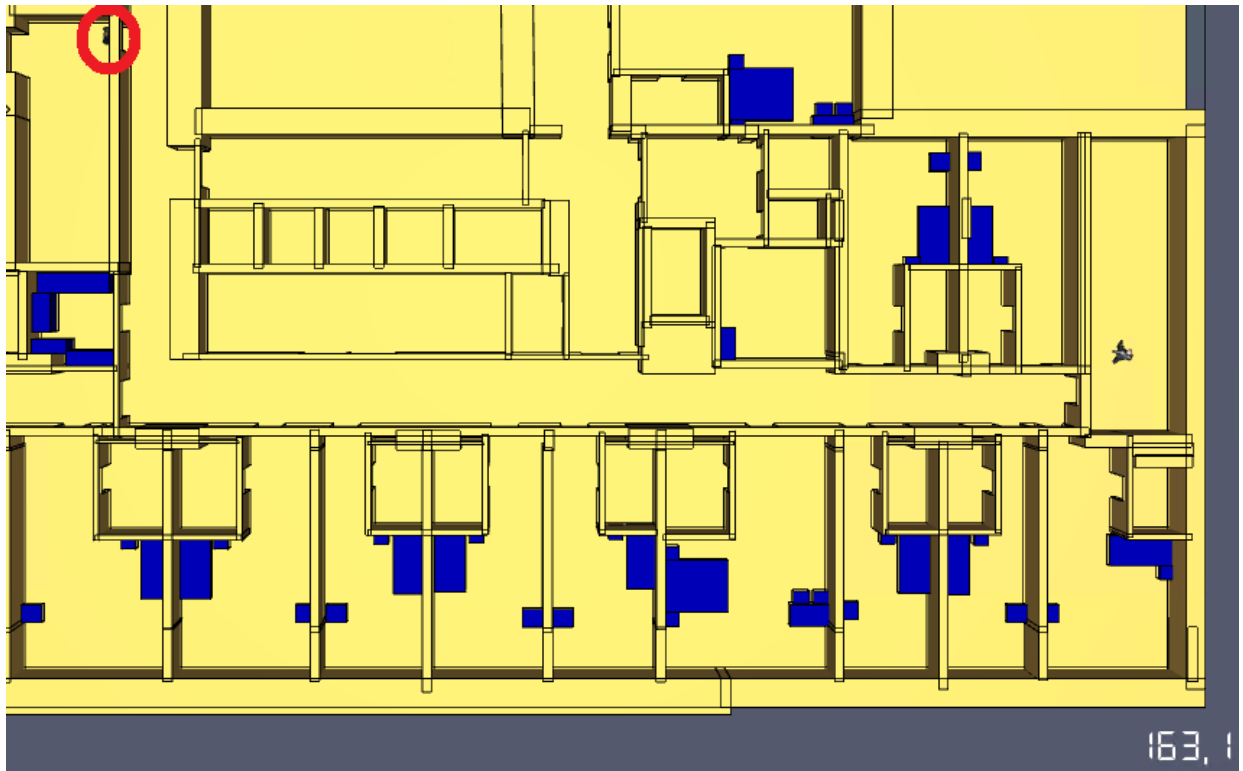
Рис. 95. Модель евакуації людей на фрагменті плану 4 поверху станом на 163,1 с.
