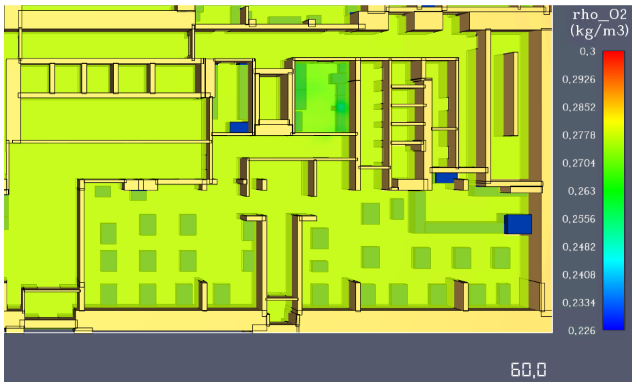
Рис. 33. Модель зниження концентрації кисню ( O_2 ) на фрагменті плану 1 поверху станом на 60,0 с.
