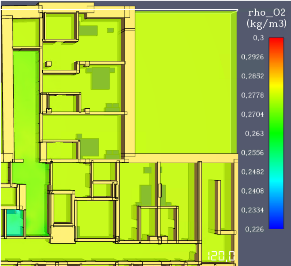
Рис. 113. Модель зниження концентрації кисню (O 2 ) на фрагменті плану 4 поверху станом на 120,0 с.
