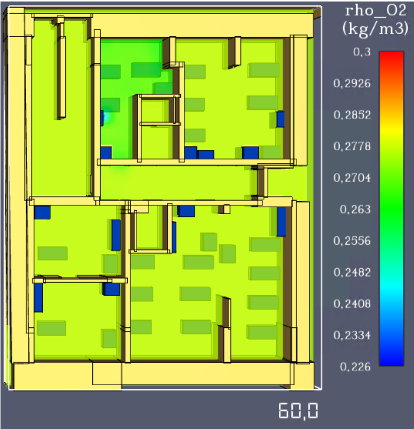
Рис. 13. Модель зниження концентрації кисню (O₂) на фрагменті плану 1 поверху станом на 60,0 с.
