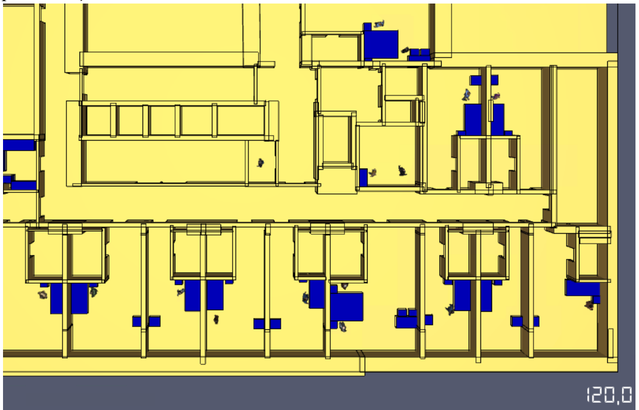
Рис. 89. Модель евакуації людей на фрагменті плану 4 поверху станом на 120,0 с.
