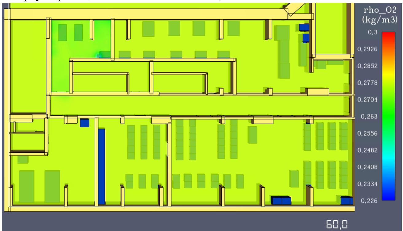
Рис. 133. Модель зниження концентрації кисню (O₂) на фрагменті плану 5 поверху з приміщенням № 523 станом на 60,0 с.
