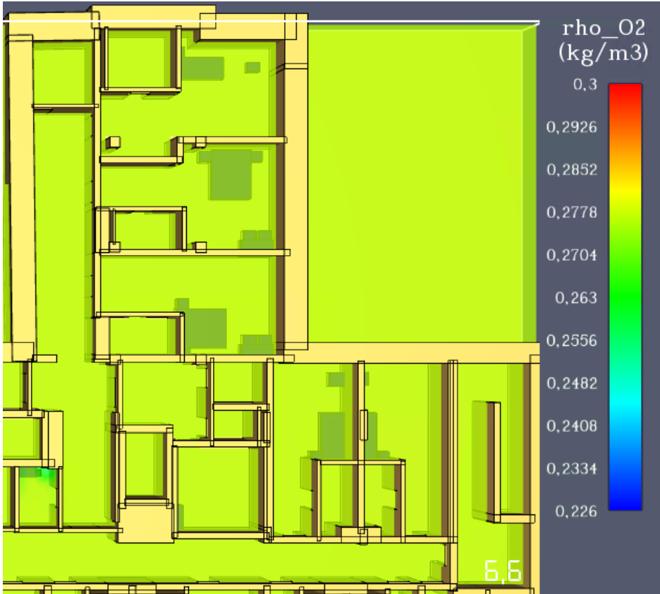
Рис. 107. Модель зниження концентрації кисню (O 2 ) на фрагменті плану 4 поверху з приміщенням № 442 станом на 6,6 с
