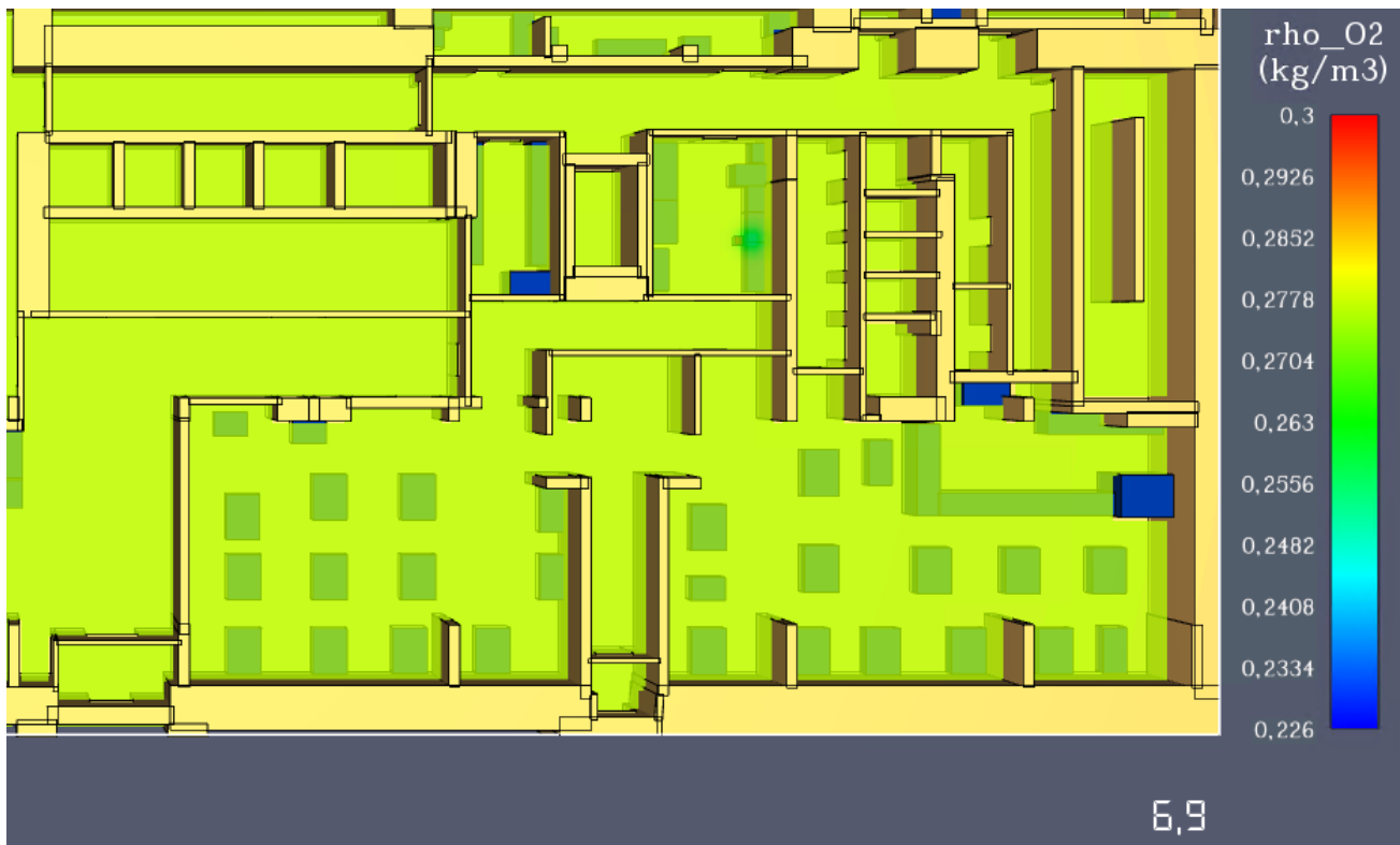
Рис. 27. Модель зниження концентрації кисню ( O_2 ) на фрагменті плану 1 поверху станом на 6,9 с.
