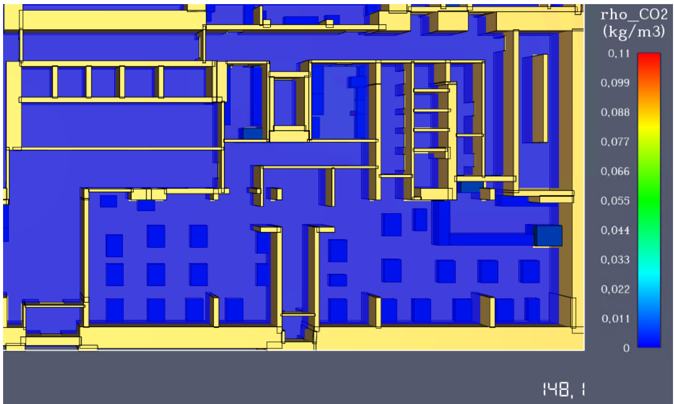
Рис. 37. Модель розповсюдження вуглекислого газу (CO 2 ) на фрагменті плану 1 поверху станом 148,1 с.
