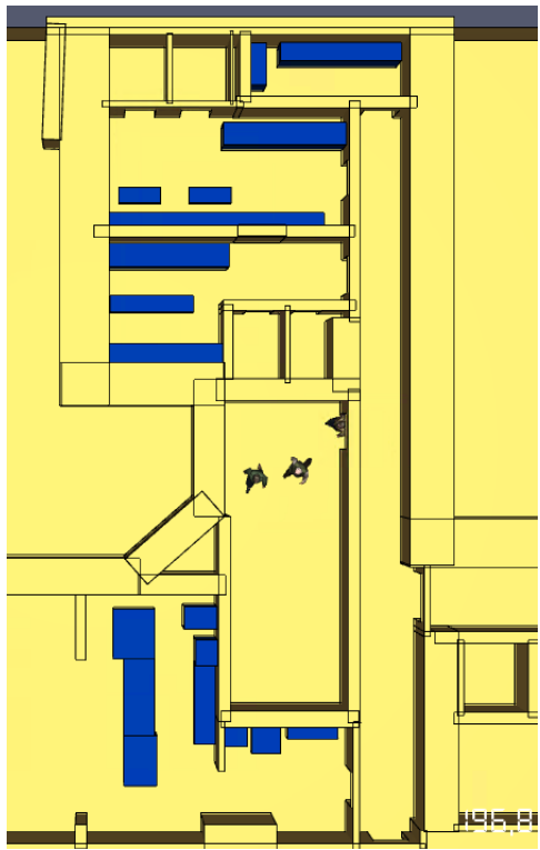
Рис. 175. Модель евакуації людей на фрагменті плану 5 поверху з приміщенням № 515 станом на 196,8 с.
