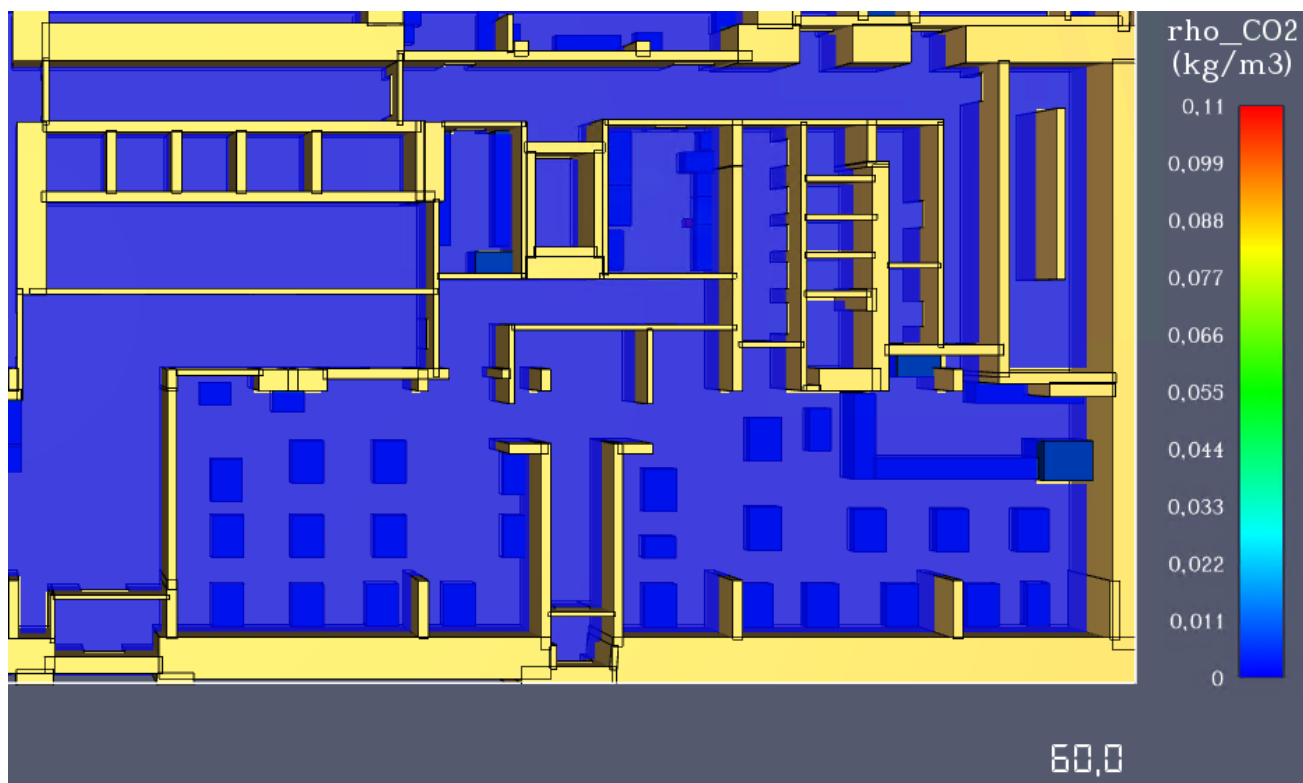
Рис. 31. Модель розповсюдження вуглекислого газу (CO 2 ) на фрагменті плану 1 поверху станом на 60,0 с.
