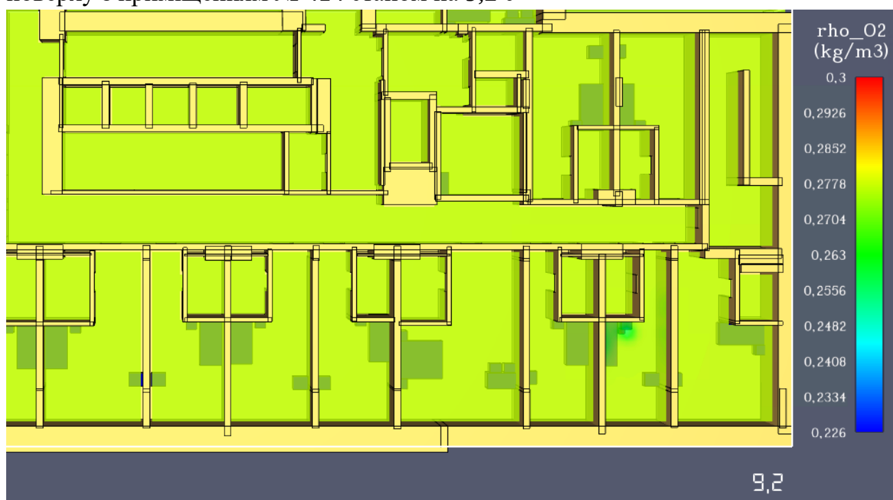
Рис. 87. Модель зниження концентрації кисню (O₂) на фрагменті плану 4 поверху з приміщенням № 414 станом на 9,2 с
