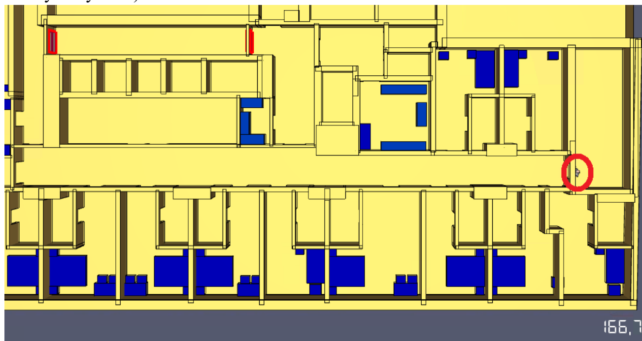
Рис. 215. Модель евакуації людей на фрагменті плану 6 поверху з приміщенням № 617 станом на 166,7 с.
