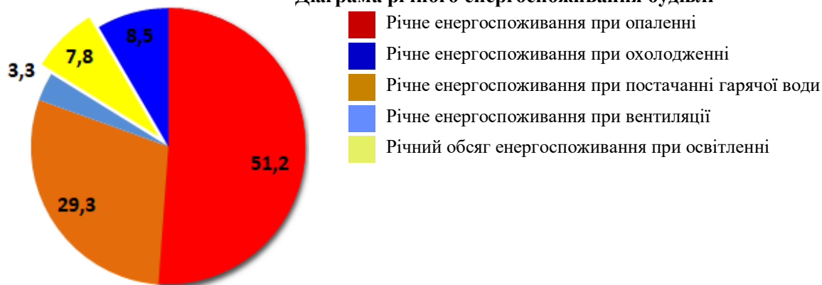
Діаграма річного енергоспоживання будівлі
