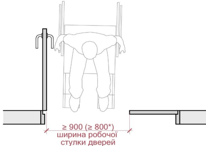
Рисунок 7е – Ширина робочої частини (стулки) в просвіті
