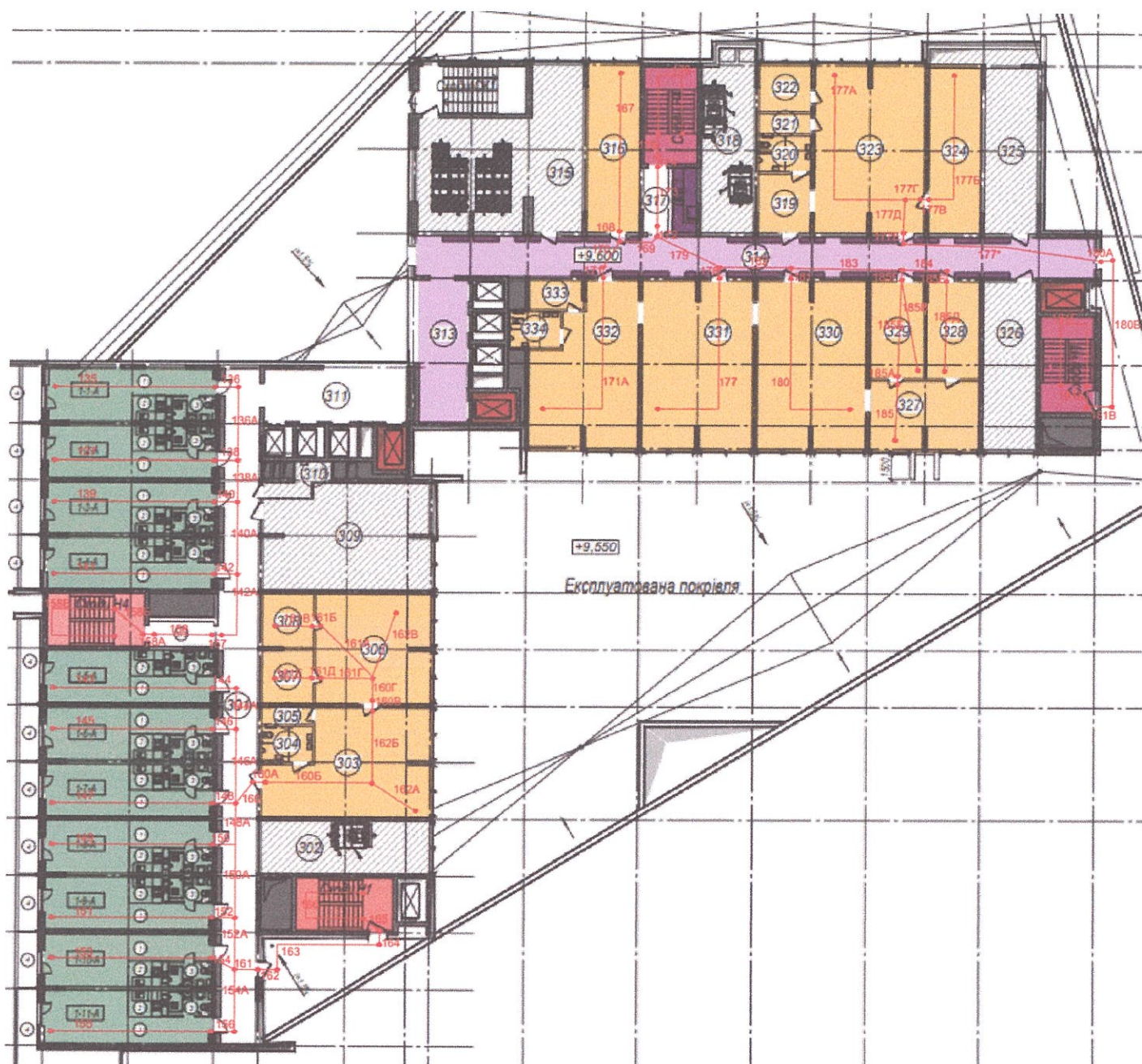
Рисунок 2.4 Схема евакуації людей із відмітки+5,400 (третій поверх) комплексу
