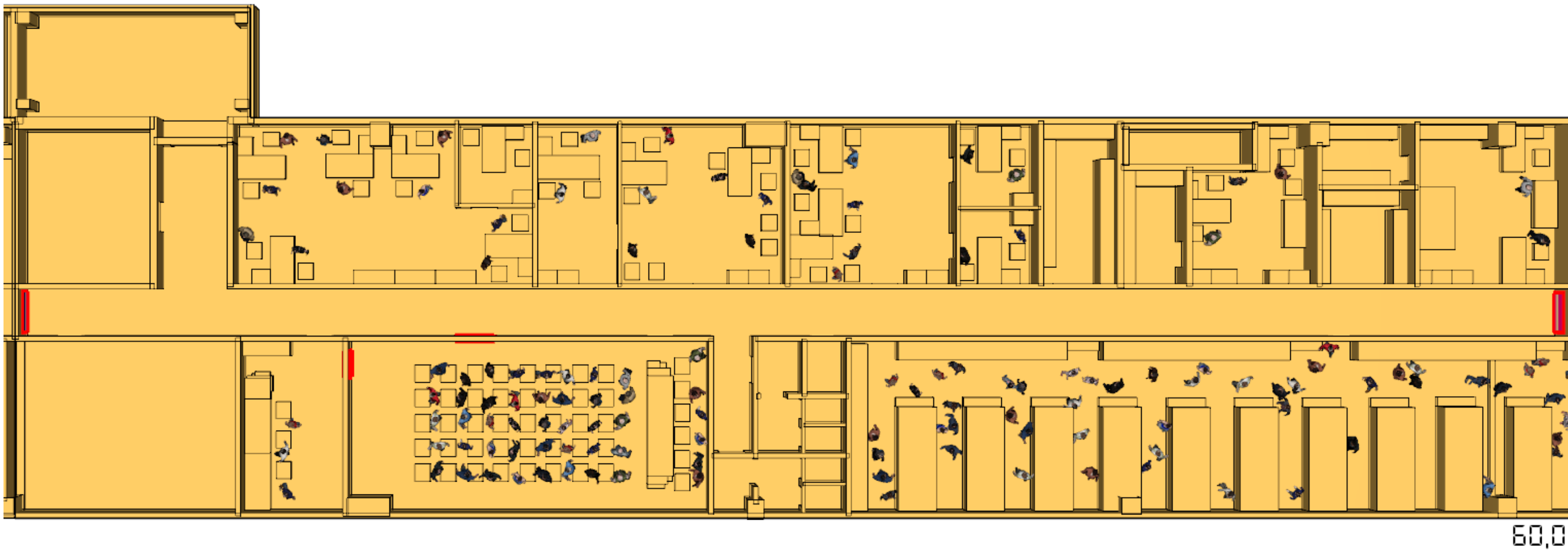
Рис. 104. Модель евакуації людей на фрагменті плану на відмітці +4,200 станом на 60,0
