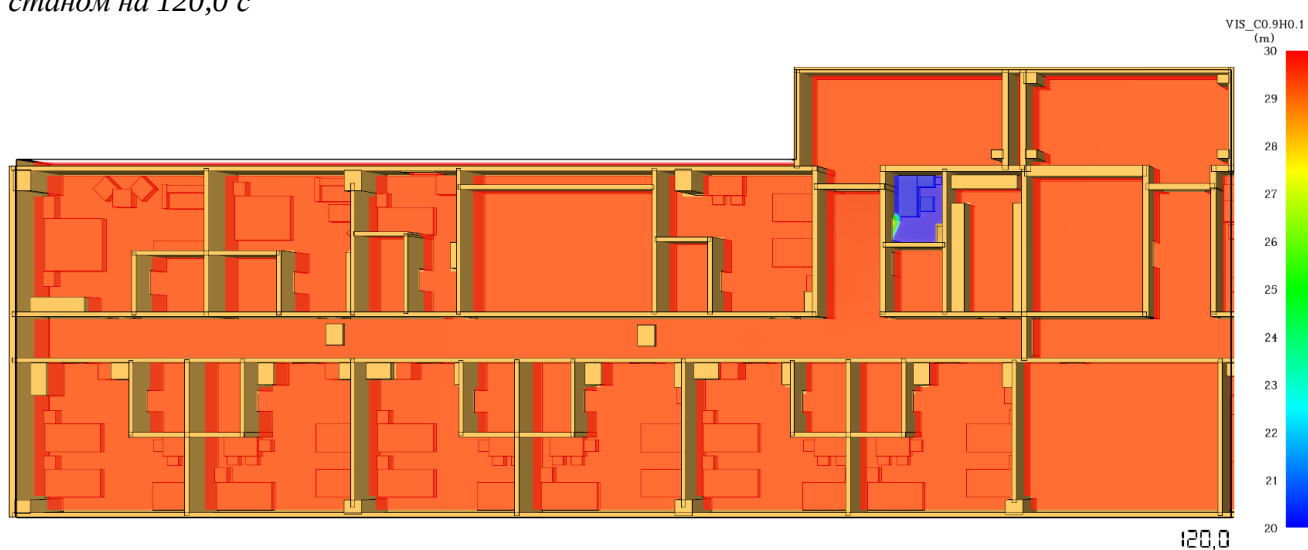
Рис. 132. Модель втрати видимості на фрагменті плану на відмітці +4,200 станом на 120,0 с
