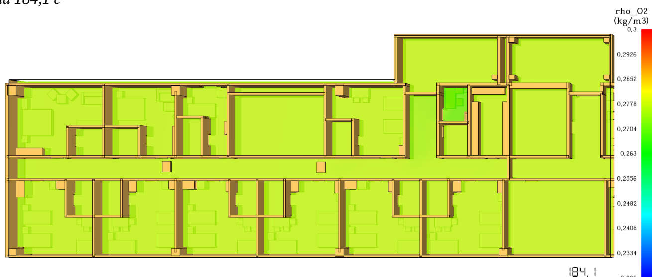
Рис. 138. Модель зниження концентрації кисню ( O_2 ) на фрагменті плану на відмітці +4,200 станом на 184,1 с
