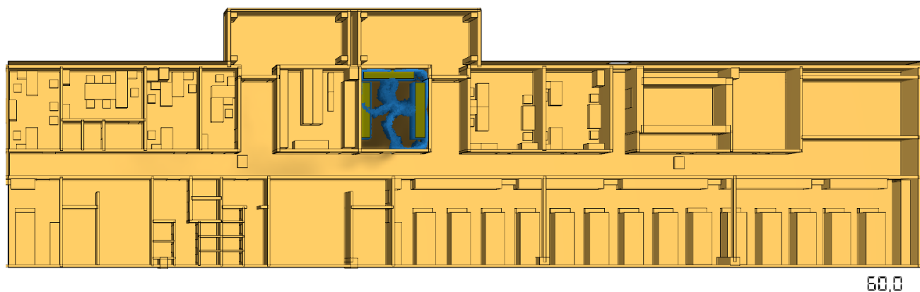
Рис. 87. Модель візуалізації системи водяного спринклерного пожежогасіння на фрагменті плану на відмітці +4,200 станом на 60,0 с
