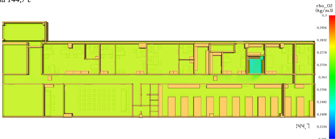
Рис. 115. Модель зниження концентрації кисню ( O_2 ) на фрагменті плану на відмітці +4,200 станом на 144,7 с
