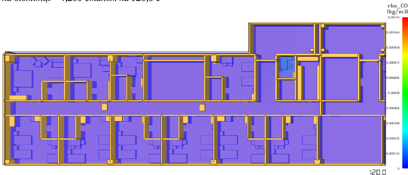
Рис. 130. Модель розповсюдження чадного газу (CO) на фрагменті плану на відмітці +4,200 станом на 120,0 с
