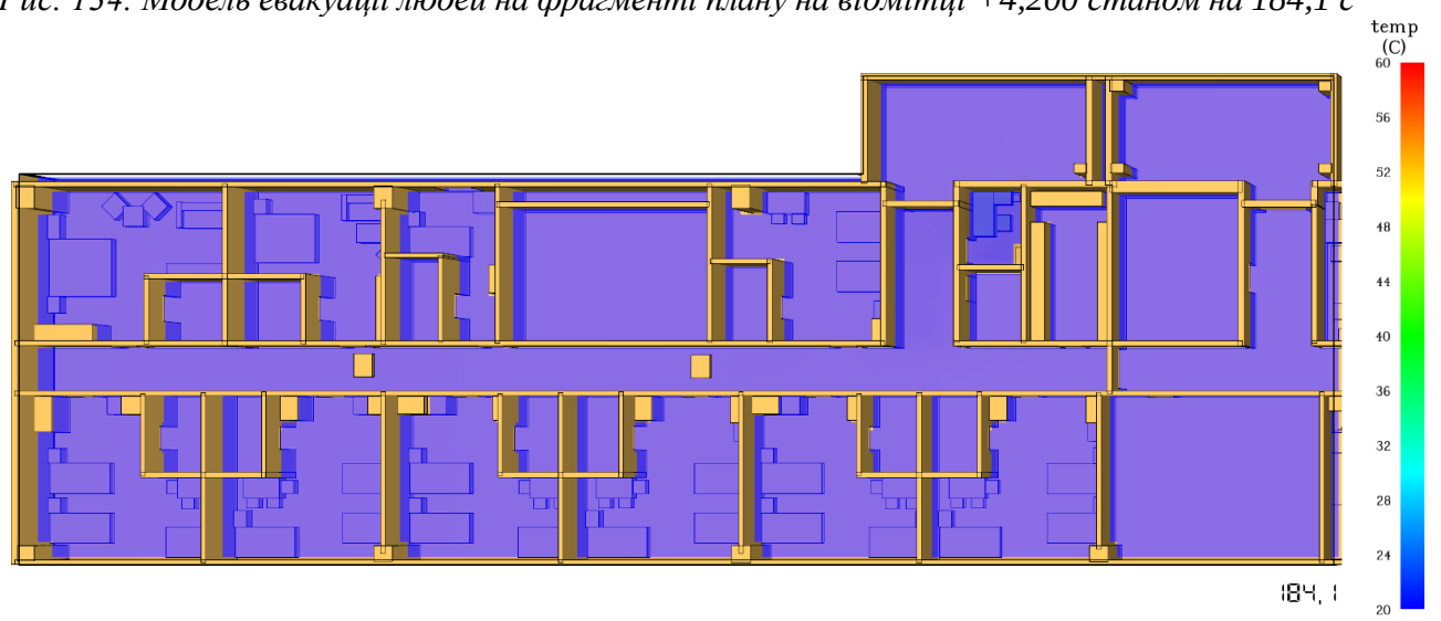
Рис. 135. Модель розповсюдження температури на фрагменті плану на відмітці +4,200 станом на 184,1 с
