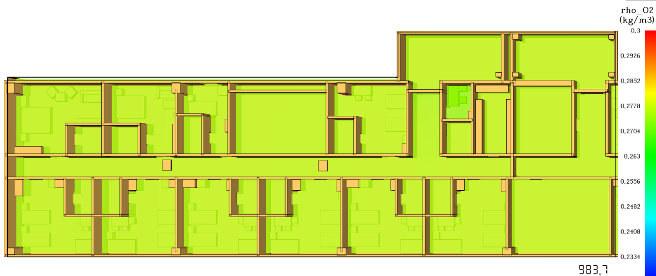
Рис. 145. Модель зниження концентрації кисню ( O_2 ) на фрагменті плану на відмітці +4,200 станом на 983,7 с
