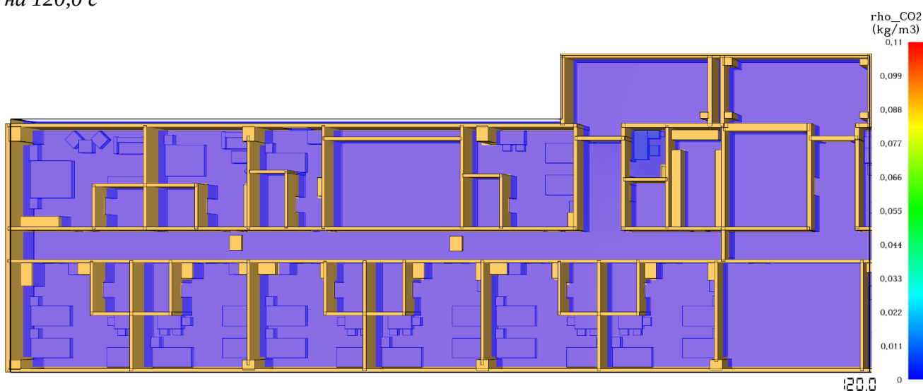
Рис. 129. Модель розповсюдження вуглекислого газу (CO 2 ) на фрагменті плану на відмітці +4,200 станом на 120,0 с
