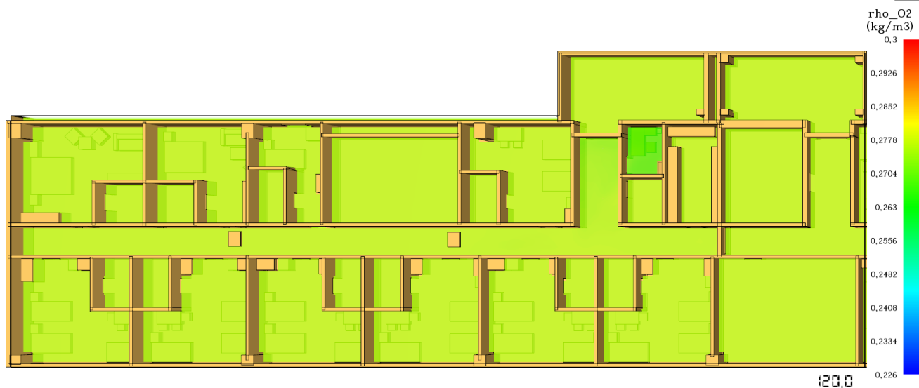
Рис. 131. Модель зниження концентрації кисню ( O_2 ) на фрагменті плану на відмітці +4,200 станом на 120,0 с
