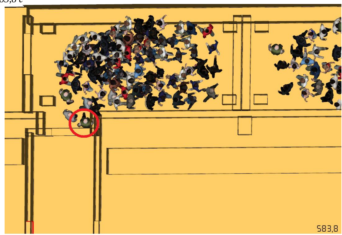
Рис. 42а. Збільшений фрагмент моделі евакуації людей на плані 2 поверху станом на 583,8 с
