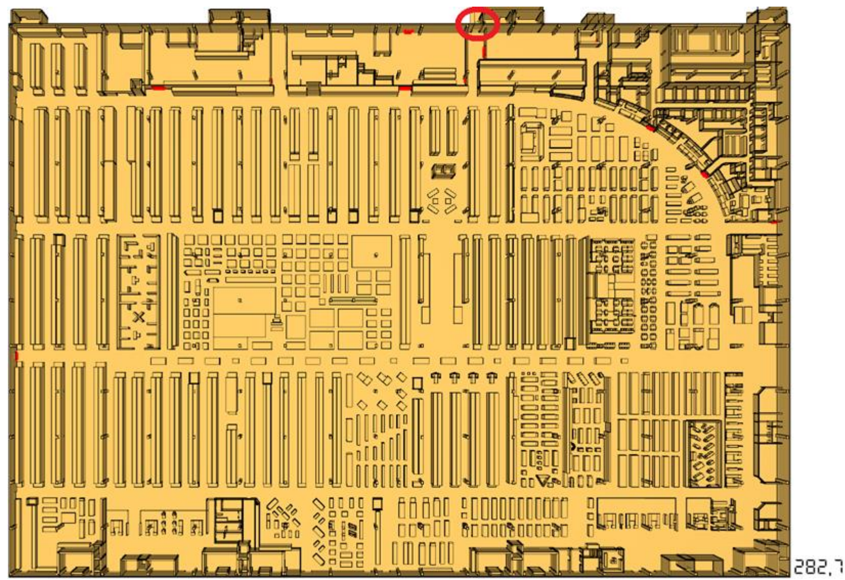
Рис. 26. Модель евакуації людей на плані 1 поверху станом на 282,7 с
