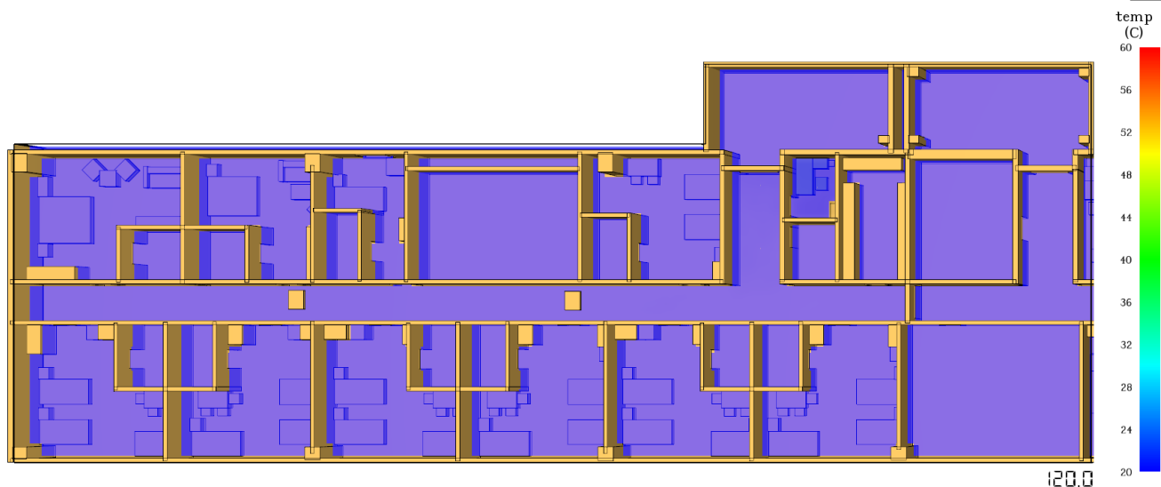
Рис. 128. Модель розповсюдження температури на фрагменті плану на відмітці +4,200 станом на 120,0 с
