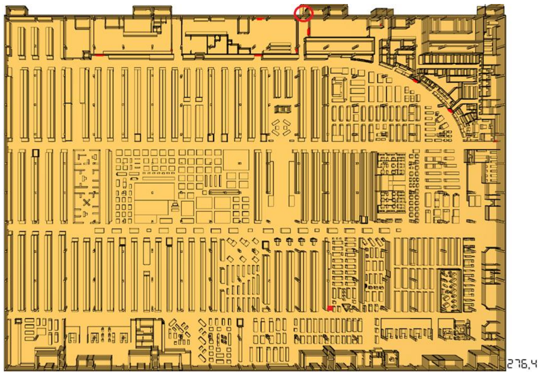
Рис. 10. Модель евакуації людей на плані 1 поверху станом на 276,4 с
