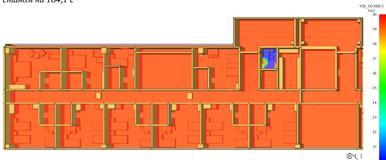
Рис. 139. Модель втрати видимості на фрагменті плану на відмітці +4,200 станом на 184,1 с
