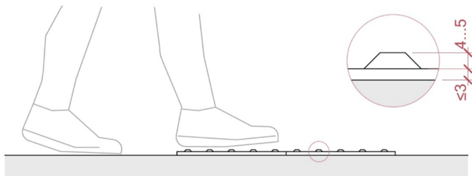
Рисунок 28б — Приклад укладання тактильного індикатора на поверхні шляху руху (Рисунок 28б долучено, Зміна № 2, графічна частина змінено, Зміна № 3)
