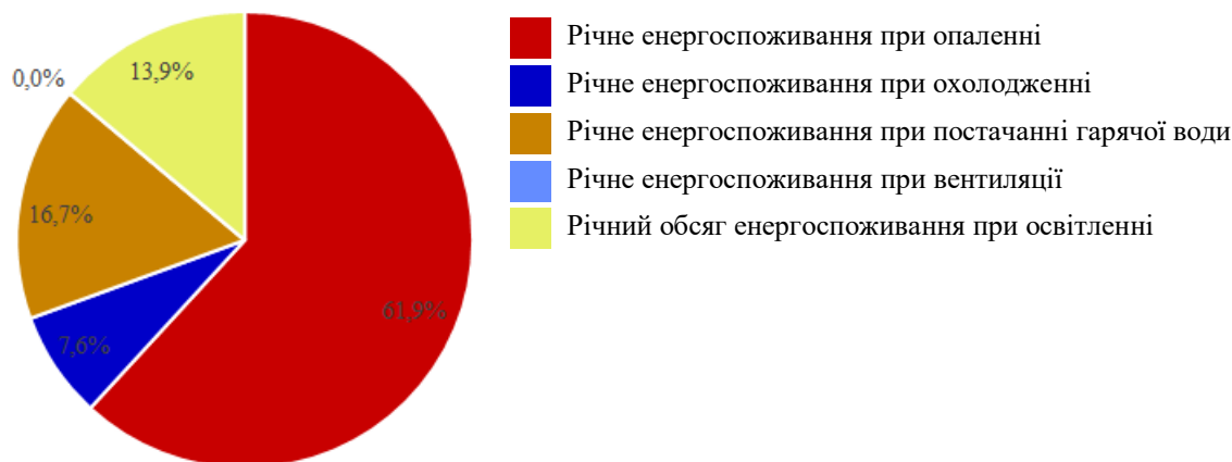
Діаграма річного енергоспоживання будівлі
