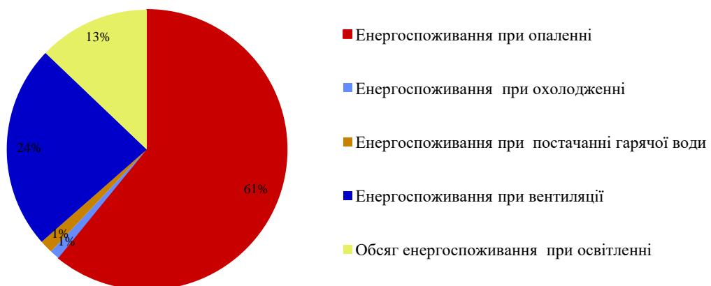
Діаграма річного енергоспоживання будівлі
