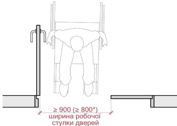
Рисунок 7е – Ширина робочої частини (стулки) в провітрі
