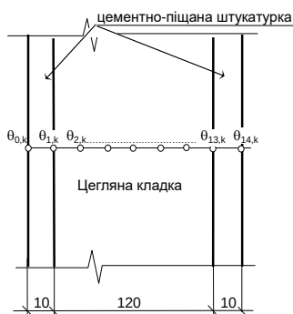
Рис. 7.3. Кінцево-різницева схема для розв'язку задачі теплопровідності при визначенні температур у перерізі ненесучої стіни СЦ-1.
